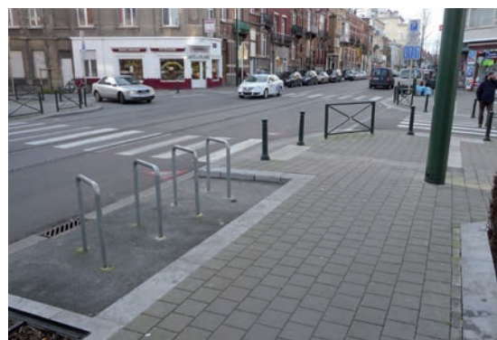
Ranges-vélo placés en dehors du cheminement piéton.
